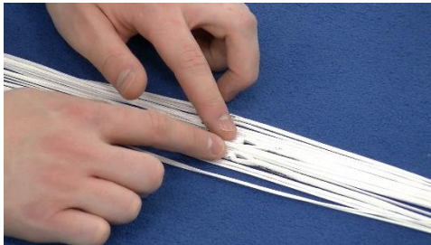
Bild 14.3.3.21 In den Leinenbündeln kontrollieren, ob die Steuerleinen noch auf gleicher Höhe sind
