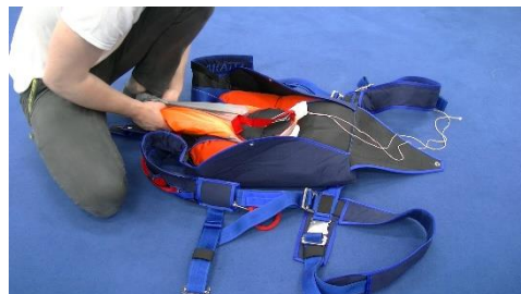
Bild 14.4.3.4 Stoff des Federhilfsschirms nach oben herausführen
