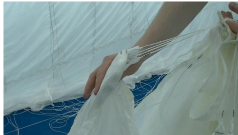
Bild 14.3.2.4 Steuerleinenbündel beidseitig auf freien Verlauf prüfen
