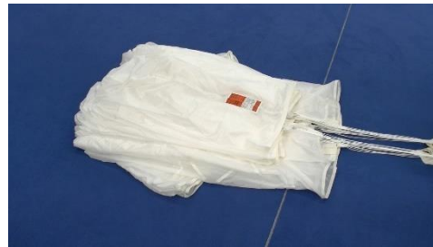
Bild 14.3.3.2 Zu beachten sind die symmetrisch angeordneten Zellöffnungen rechts und links der Fallschirmkappe
