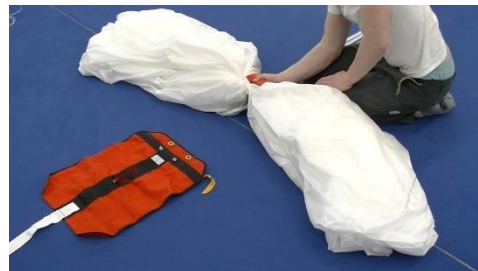
Bild 14.3.3.6 Unteren Teil der Mittelzelle auffächern und unterchieben, Mittelzelle komprimieren
