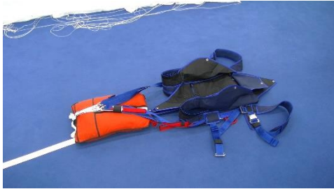
Bild 14.4.1.1 Freebag gepackt, Gurtzeug/Container ausgelegt
