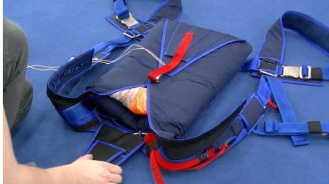
Bild 14.4.3.7 Öse der Klappe 5 über der Loop-Öse positionieren, Loop hindurchführen und mit Vorstecker fixieren, Kappe des Federhilfsschirms locker einrollen und im Container verstauen
