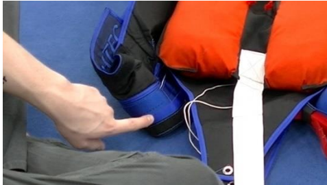
Bild 14.4.1.9 Die Tragegurte zum Schutz vor Beschädigung durch das Klettband unter dem Gewebeband verstauen
