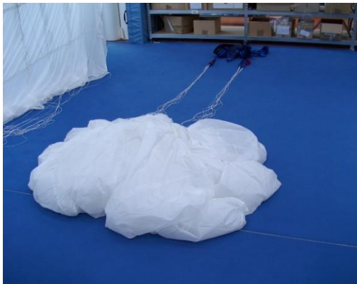
Bild 14.2.3 Gurtzeug/Container und Fallschirmkappe auslegen, Kontrollieren der Kappe
