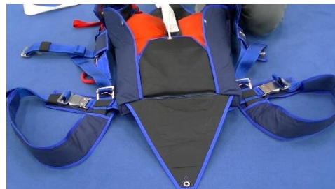
Bild 14.4.2.2 Verstauen des Freebags im Container
