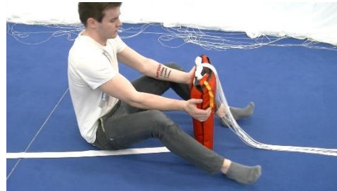
Bild 14.3.3.22 Fixierung des Gurtzeugs lösen (Bild 14.2.4) Den gepackten Freebag auf die Rückseite wenden
