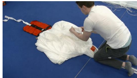
Bild 14.3.3.4 Das Teilen der Kappe vorbereiten, dazu oberen Teil der Mittelzelle auffächern
