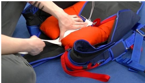
Bild 14.4.2.5 Die Hilfsschirmverbindungsleine zwischen Oberkante Freebag und Loop in 3 Schlägen übereinanderlegen
