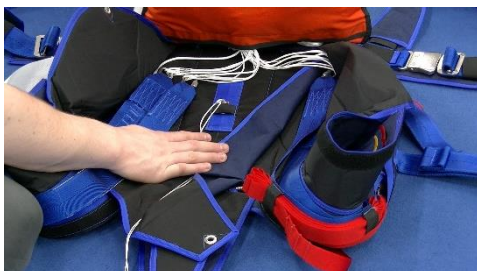
Bild 14.4.1.7 Tragegurte links verstauen
