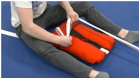
Bild 14.3.3.23 Die Leinenbündel abwechselnd in Schlaufen links und rechts in die Leinentasche des Freebags schieben
