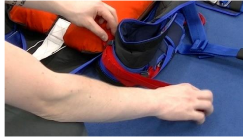
Bild 14.4.1.10 Auf korrekten Verlauf der RSL achten
