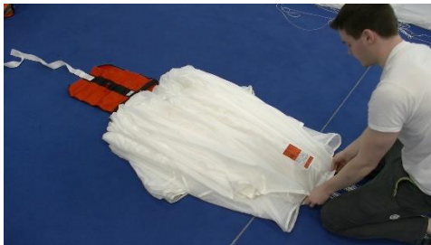
Bild 14.3.3.3 Freebag bereitlegen, mittlere Zelle um die Leinen legen und fixieren
