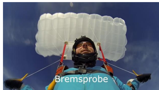
Bild 7.2.1.2 Vorbremse gelöst, Bremsprobe durchführen
