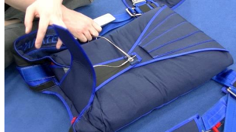
Bild 14.4.3.8 Öse der Klappe 6 über der Loop-Öse positionieren, Loop hindurchführen und mit Verschlusspin fixieren
