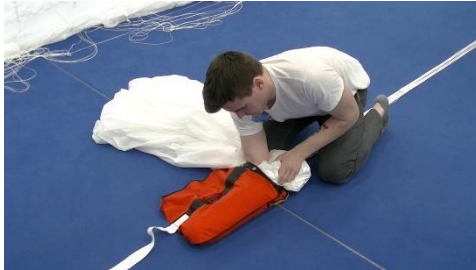
Bild 14.3.3.11 Kappenbündel (links) Kopf voran vollständig in die linke Kammer des Freebags schieben
