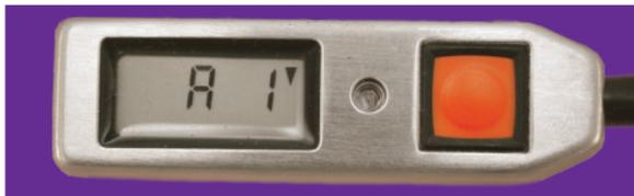
Nach dem Start, ab einer gewissen Höhe, ist die eingestellte Nummer konstant sichtbar.
