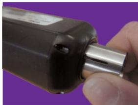
Den Filterwechsler leicht zusammendrücken und den Filter mit einer Drehbewegung gegen den Uhrzeigersinn abschrauben und entfernen. Eventuelle
