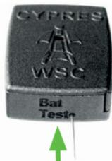
reise einen Batteriecheck durch. Wenn die Prüfung fehlschlägt: Nehmen Sie die Batterie heraus und schieben Sie sie innerhalb von 10 Sekunden wieder ein. Wiederholen Sie den Batteriecheck. Wenn die Überprüfung fehlschlägt, wechseln Sie die Batterie. In jedem Fall: Überprüfen Sie anschließend die Funktionalität des Audios.
