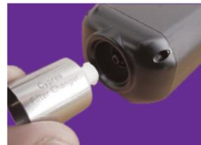
Den Filterwechsler im Bereich ohne Nuten fassen und den Filter mit dem Bajonettverschluß voran in das Gerät eindrehen. Dabei nicht verkanten. Der Bajonettverschluß des Filters muß anfänglich fast ohne Widerstand in das Gehäuse einzuführen und drehbar sein. Den Filterwechsler drehen bis er sich über dem Filter weggedreht hat (Filter ist stehengeblieben und Filterwechsler hat sich noch gedreht). Dann den Filterwechsler ohne zu verkanten vom Filter abziehen.
