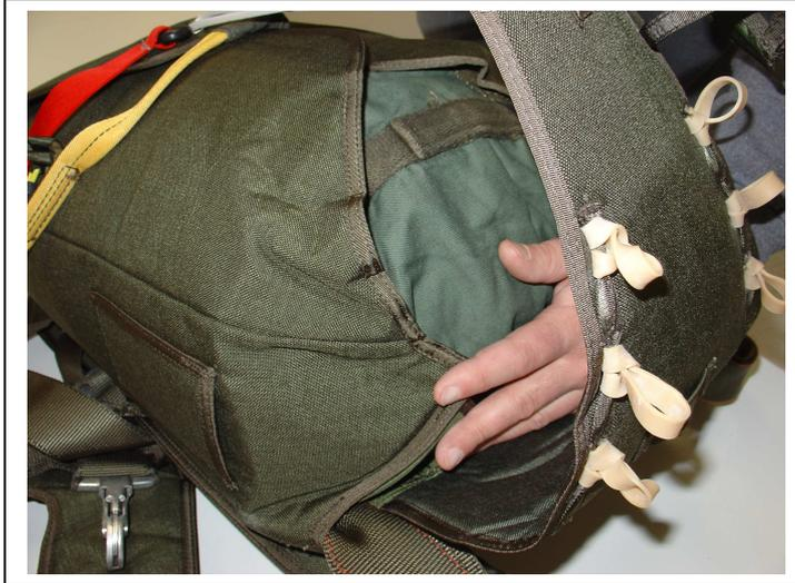
Diese mit einer Hand dort fixieren und über die so gehaltenen Klappen mittels der Packschnur die vierte Klappe ziehen und mit dem Vorstecker fixieren. Nach der Kontrolle und einem Verstreichen der Packhülle wird der Vorstecker durch den Softpin der Aufzugsleine ersetzt. Die Packschnur wird entfernt, und Pinabdeckklappe wird mittels der Einstecklasche geschlossen.
