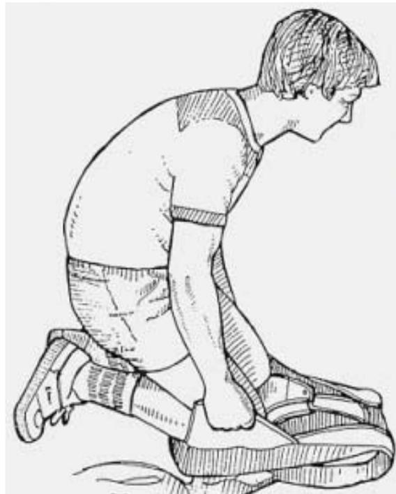
Lege den inneren Container mit den Fangleinen nach unten in den Hauptcontainer des Gurtzeuges. Erfasse danach die seitlichen Verschlussklappen und drücke das Paket hinein (Bild oben rechts).
