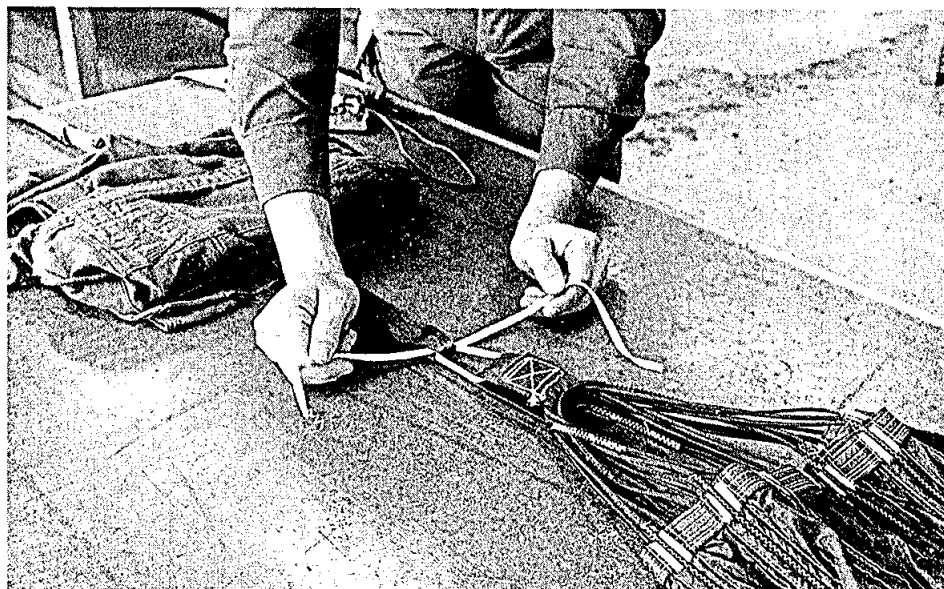
Bild 22 Sollbruchstelle Scheitelschleufe - innere Gurtschleufe
