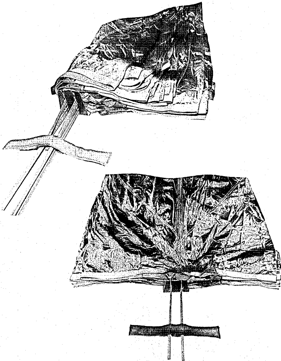
Bild 17 Aufstecken des Fangleinenordners, Phasenablauf
