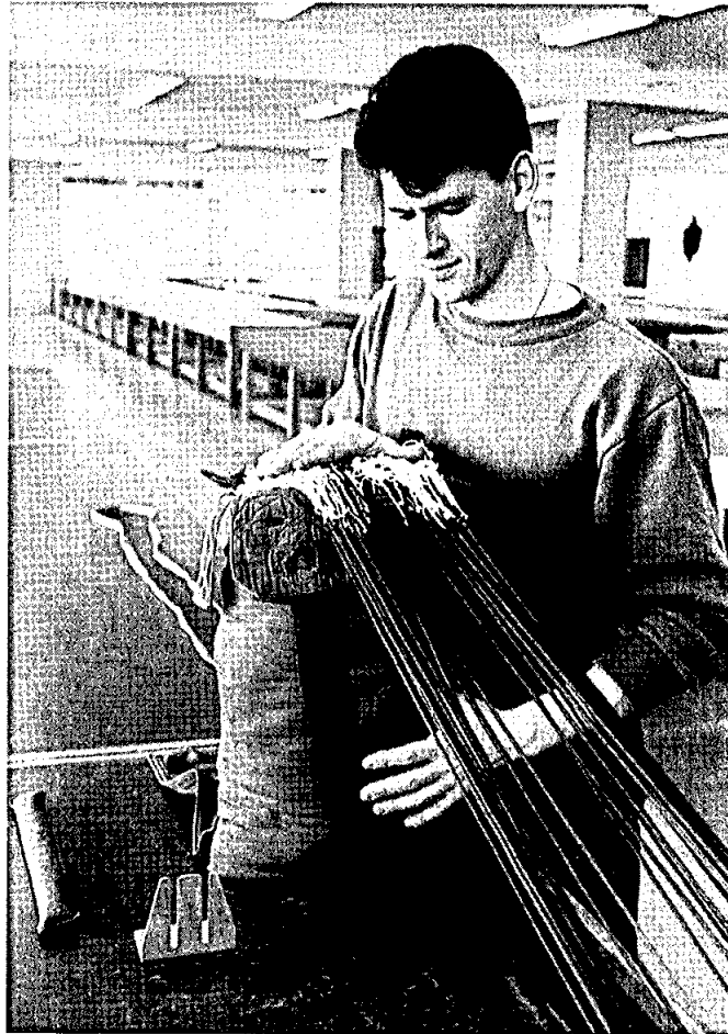
Bild 25 Einlegen der Fangleinen mit Basisnetz in den Verpackungssack
