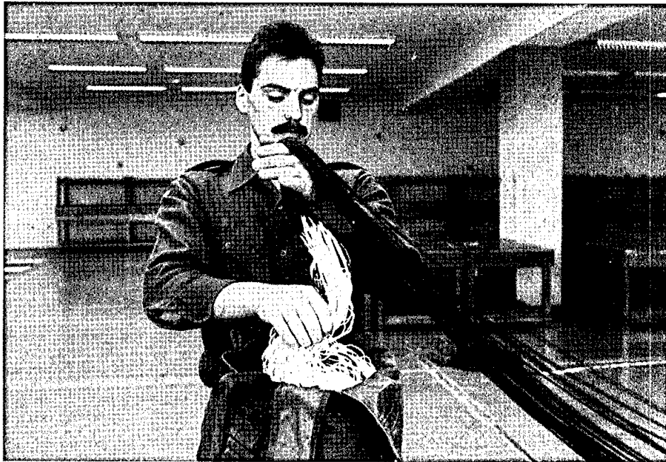
Bild 30A Einlegen der Fangleinen mit Basisnetz in den Verpackungssack
