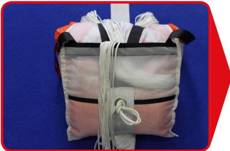
Verschließe das Freebag durch zwei Schlaufen der Fangleinen. Verwende ausschließlich Safety Stows von Sife in der jeweils richtigen Größe und kein Gummiband. Die zwei Schlaufen sollen nicht kleiner als 5cm und nicht größer als 7cm sein. Um die Reservefangleinen zu schützen, stelle sicher, dass der männliche Klettverschluss abgedeckt ist.
