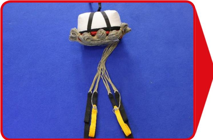
Schlaufe die Hauptfallschirmfangleinen in S-Schlaufen ein und achte darauf genügend Überlänge zu lassen. Die Überlänge sollte zwischen 38 cm-50cm lang sein.
