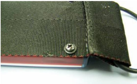
Lege die Handschlaufe auf die Rückseite des Neptune und richte die 4 Löcher in der Schlaufe mit den vier Gewindeöffnungen im Neptune aus. Schraube die Schlaufe mit den mitgelieferten Schrauben fest. Achte darauf, dass die Unterlegscheiben zwischen Schraubenkopf und Handschlaufe liegen (nicht zwischen Handschlaufe und Neptune).
