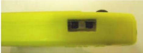
Der Neptune hat eine eingebaute Infrarotschnittstelle. Diese Schnittstelle ist kompatibel zum IrDA Standard und erlaubt so eine Verbindung zu Deinem PC.
