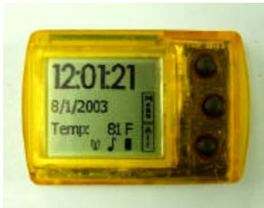
Nach dem Starten des Systems siehst Du die Bodenanzeige. Es werden Zeit, Datum und Temperatur angezeigt.
