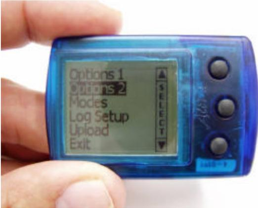
Alle Menü funktionieren nach dem gleichen Prinzip: Die obere und die untere Taste bewegen den Cursor; die mittlere Taste wählt den gerade markierten Punkt aus.
