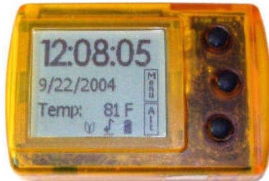
Am Boden zeigt das Display die Zeit, das Datum und die Temperatur an. Weiterhin werden Symbole für die Hintergrundbeleuchtung, das Logbuch, Warntöne und die Batterie angezeigt.
