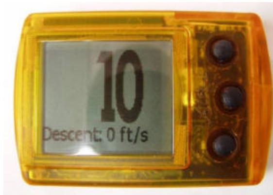
Die Anzeige am Schirm zeigt die Höhe über Grund mit einer Auflösung von 10 ft (3 m) an. Außerdem wird die Sinkrate in ft/s angezeigt (Fuß pro Sekunde).
