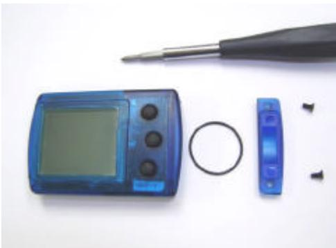
Löse die beiden Schrauben der Batterieabdeckung mit einem Kreuzschlitz-Schraubendreher und entferne die Abdeckung.
