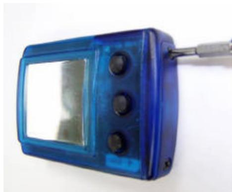
Schraube die Abdeckung mit den zwei Kreuzschlitz-Schrauben wieder fest. Achte darauf, die Schrauben nicht zu fest anzuziehen, damit die Abdeckung keine Risse bekommt (dies könnte die Wasserdichtigkeit vermindern).
