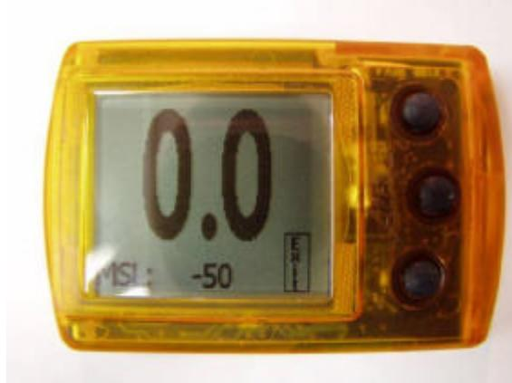
Wenn im unteren rechten Teil des Displays „Alt“ angezeigt wird (am Boden oder im Steigflug), kannst Du die untere Taste drücken, um zur Anzeige der aktuellen Höhe zu wechseln. In dieser Anzeige werden die Höhe über Grund und die Höhe über dem Meeresspiegel (MSL) angezeigt.
