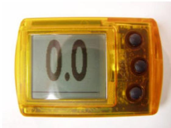
Im unteren Teil des Displays wird ein Balken angezeigt, der bei 12.000 ft (etwa 3.650 m) vollständig gefüllt ist und bei 3.000 ft (etwa 910 m) leer ist. Dieser
