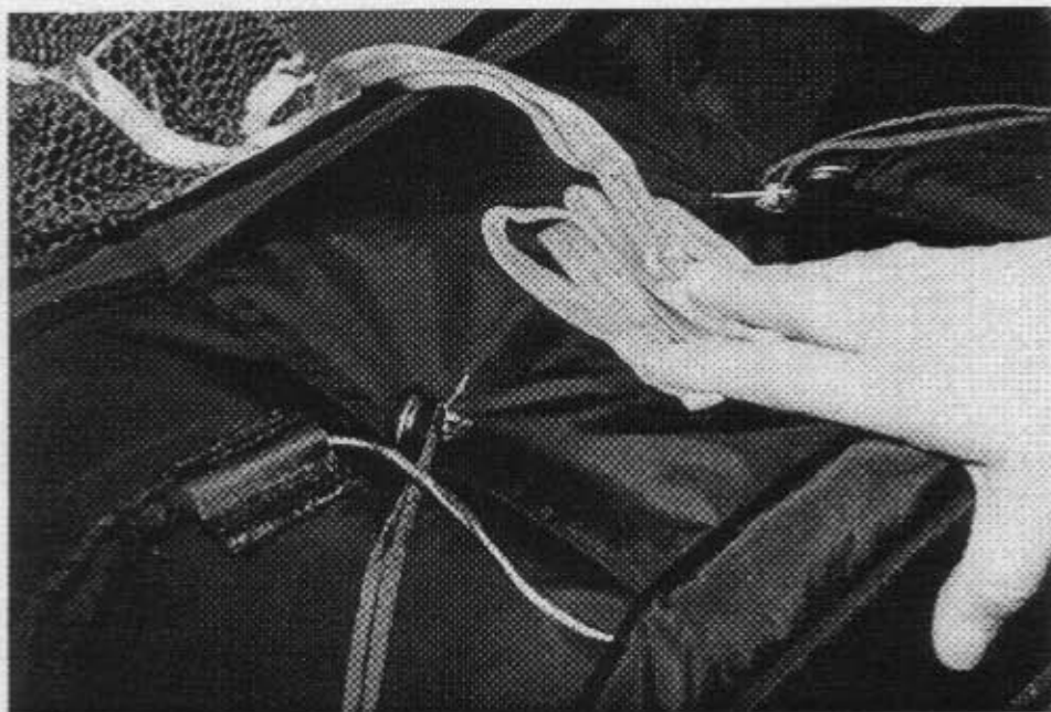
Abb.28 Hilfsschirmverbindungsleine in S-Schlägen einlegen
