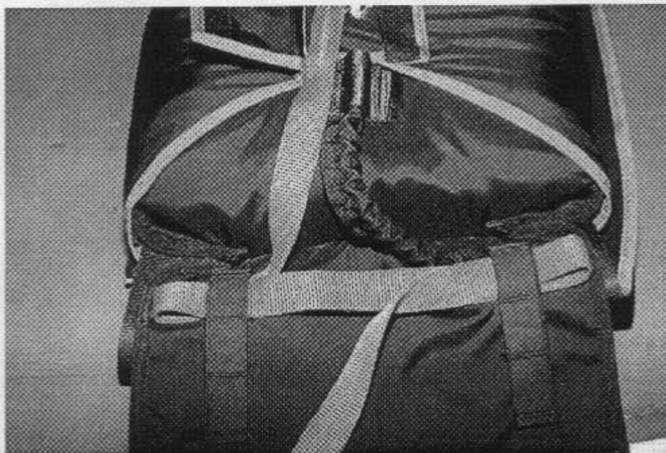
Abb. 38 Rechts unten beginnend wird die Aufziehleine in S-Schlägen eingeschlaucht
