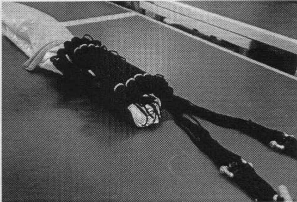
Abb. 17 Fangleinen eingeschlaucht. Die restlichen 20 - 30 cm der Fangleinen nicht einschlaufen
