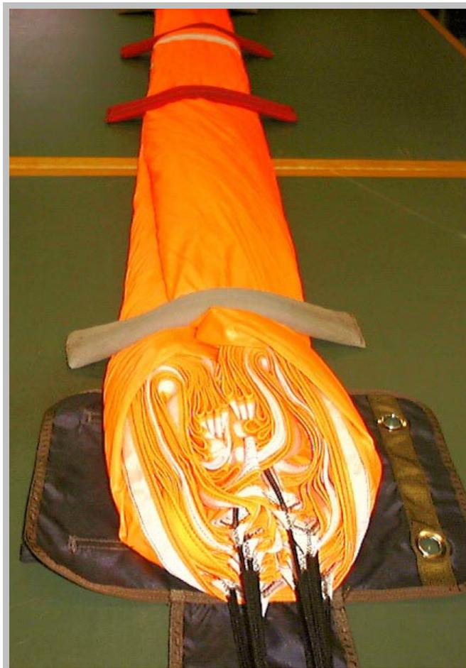
Abb. 14 Beide Kappenhälften längsgefaltet
