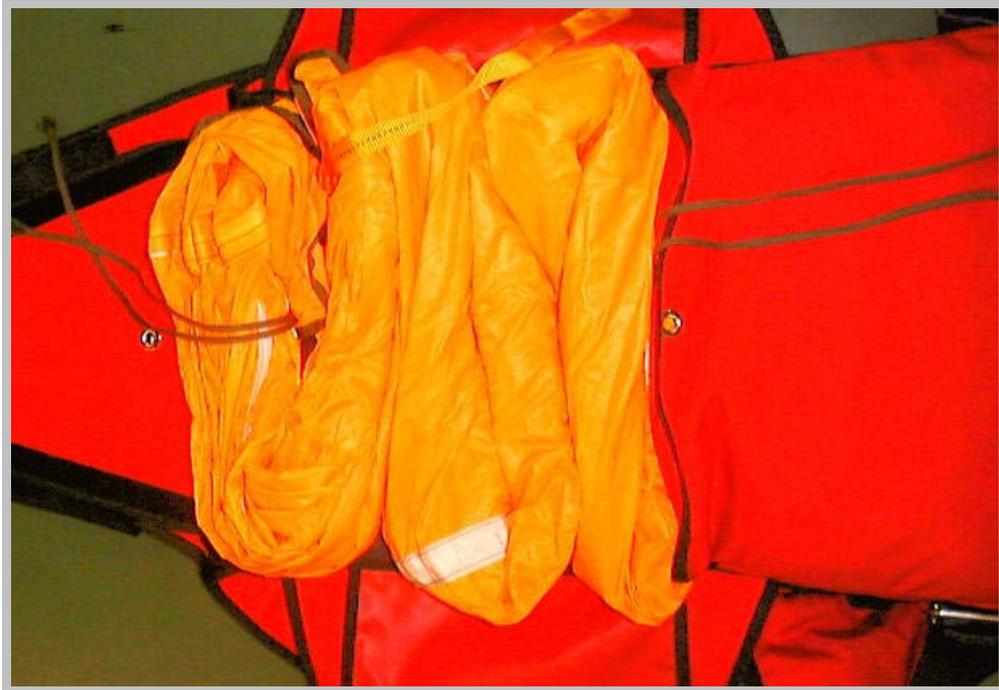
Abb. 28 Kappe in S-Schlägen gelegt, Verschlusschlaufen zwischen dem 3. und 4. Schlag, sowie zwischen dem 7. und 8. Schlag herausgeführt. Scheitelabdeckung vor den 8. Schlag gelegt.
