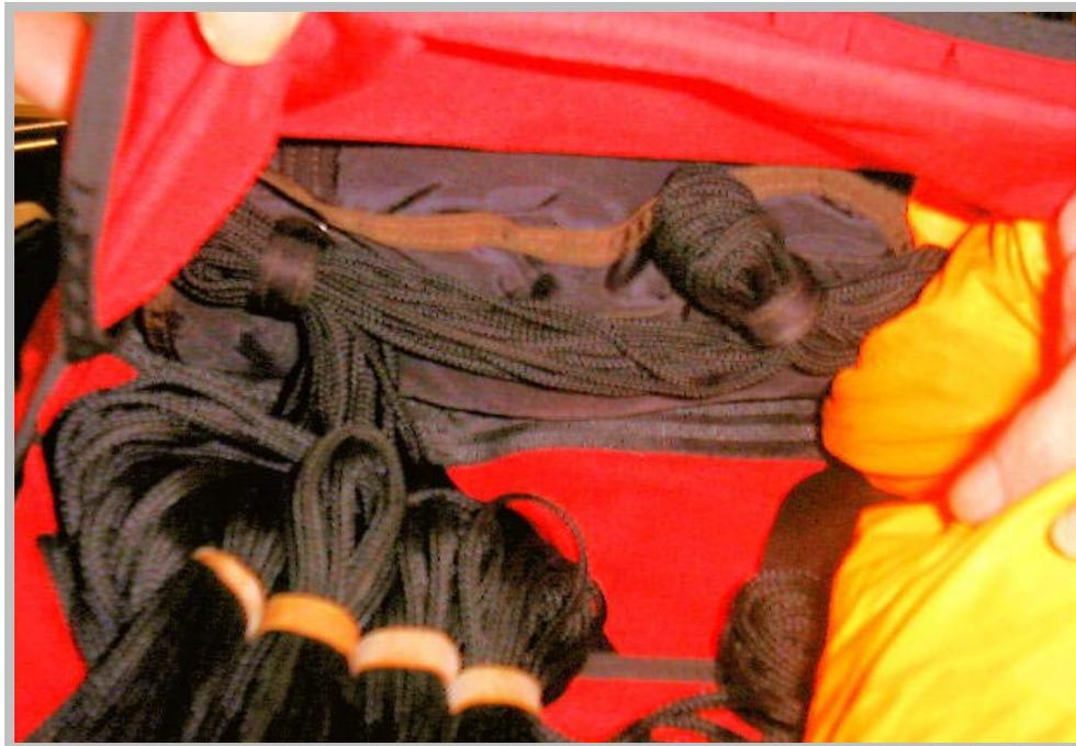
Abb. 26 Diaper in Verpackung geschoben und so gedreht, dass der Diaperverschluss in Richtung Kappe zeigt
