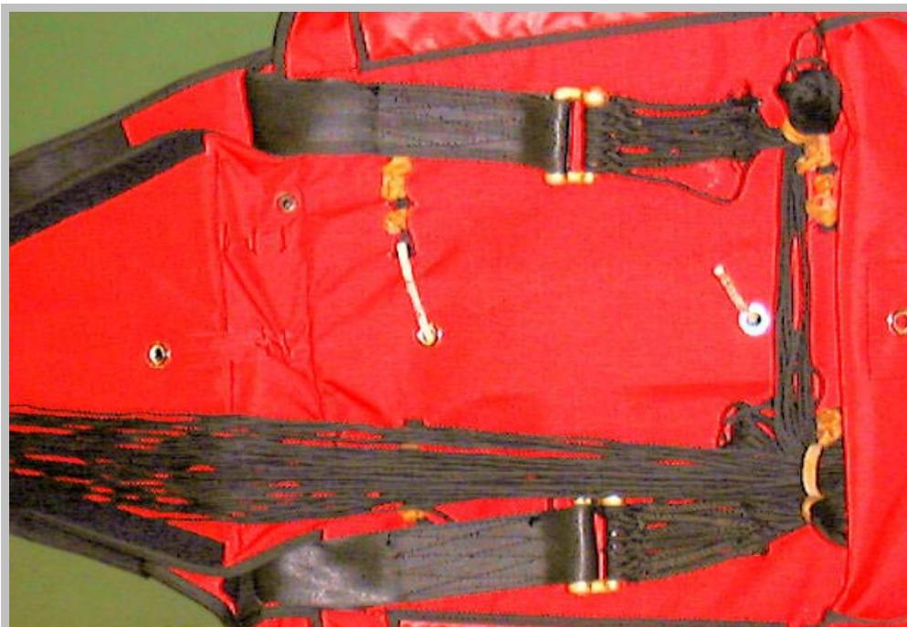
Abb. 23 Fangleinenbündel zusammengeführt und 1. Einschlaufung links befestigt
