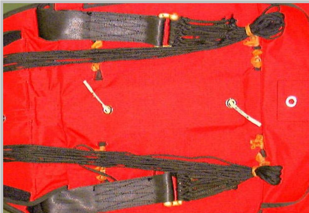
Abb. 22 Haupttragegurt in Verpackung gelegt und Fangleinen rechts und links eingeschlauff (Packgummis zweifach umschlungen).
