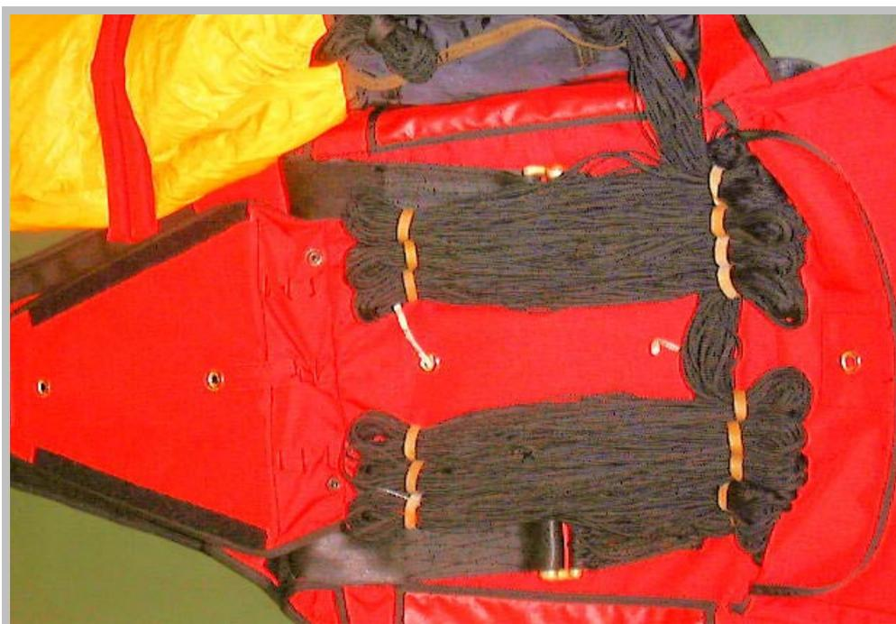
Abb. 25 Fangleinen rechts vollständig eingeschlaufft
