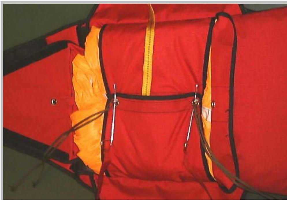
Abb. 29 Beide Hilfsschirmklappen geschlossen, Hilfsschirmverbindungsleine nach rechts herausgeführt.
