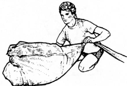
9) Schiebe die seitlichen Kappenteile zusammen und unter das Kappenbündel. Beginne dabei unter dem Slider, wobei es vorteilhaft ist, sich auf das Kappenende beim Slider zu knien. Forme dann eine flache POD-breite Bahn.
