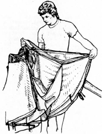
4) Nimm alle gefalteten Zellen zwischen die Knie und halte sie damit fest. Ordne nun die Stabilisatoren und den Slider. Ziehe danach den Stoff zwischen den einzelnen Leinengruppen nach außen.
