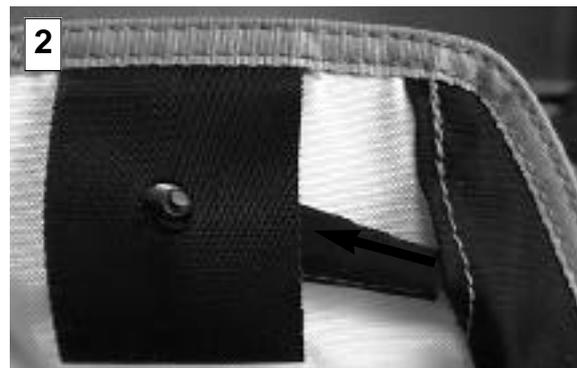
Glisser le sectionneur dans l'ouverture supérieure de la pochette, puis le faire cheminer dans le tunnel sous le rabat n° 1. Passer le sectionneur dans le tunnel élastique, et amener le trou de ce dernier sur l'oeillet du rabat.
