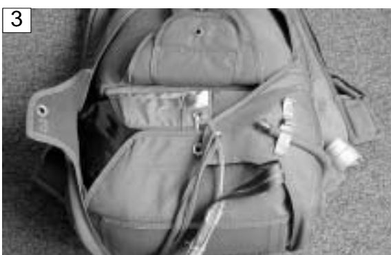
3 Fermer le rabat droit par dessus la S.O.A. Close the right flap over the static line.
