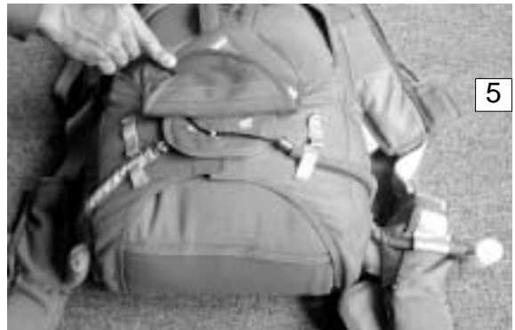
Fermer le rabat supérieur et verrouiller à l'aide du câble plastique(version E) ou de l'aiguille métallique(version D). Close the upper flap and lock with plastic cable(E version) or locking pin(D version).
