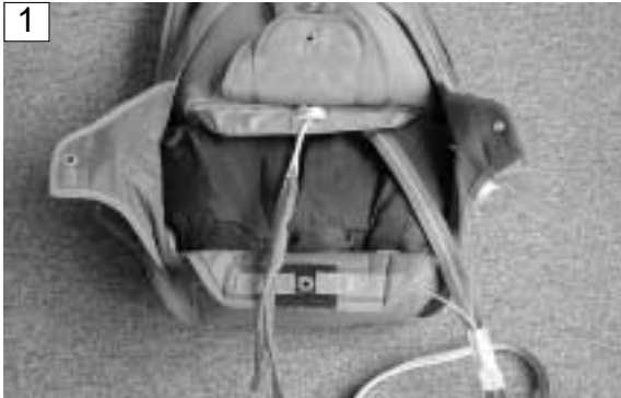
1 Dégager la S.O.A. vers la droite. Route the static line to the right side.
