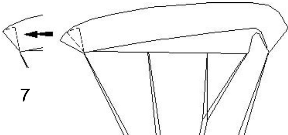
Rouler le bord d'attaque jusqu'à l'alignement du groupe de suspentes A.
