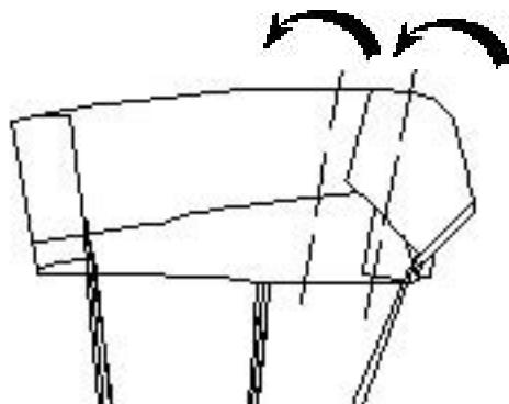
Remonter le glisseur puis le positionner dans le replis du caisson central, entre les deux stabilisateurs.
