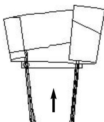
Ajuster les derniers plis de la voilure pour obtenir une largeur d'environ 5 cm supérieure à celle du POD réserve.
