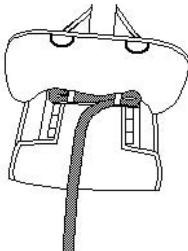
Verrouiller le rabat inférieur en effectuant deux lovages de suspentes, puis terminer le lovage des suspentes et rabattre le volet de protection.
