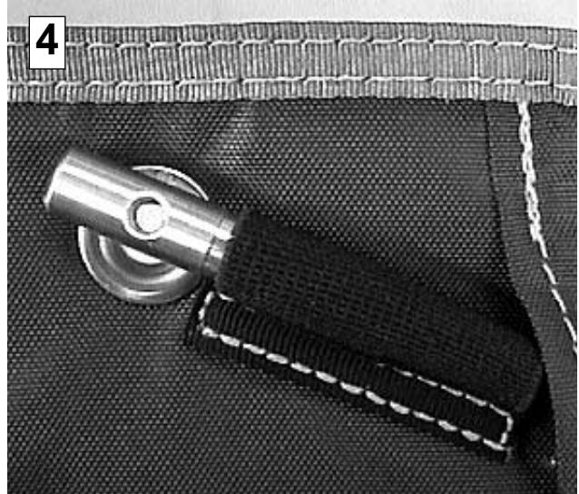
Glisser le boîtier de commande dans le tunnel situé au fond du conteneur.
