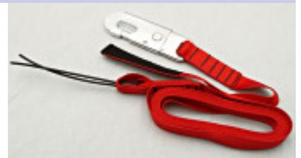
Velcro Verbindung der Aufziehleine zum Federhilfsschirm
