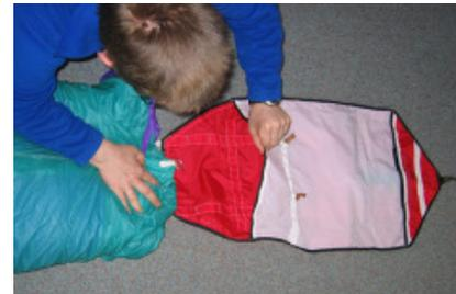
Wichtig ist die Zusatzfixierung innen im Packsack. Sie wird durch die Mittelaufhängung des Hauptschirmes gezogen und mit einem Packgummi fixiert.
