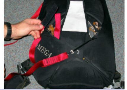
Velcroverbindung zum Federhilfsschirm anbringen.
