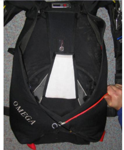
Verschließen mit dem Griffkabel, welches erst noch durch den Ring des 2 Releasegriffes geführt wurde!
