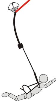
Bei Automatiksprüngen mit Federhilfsschirm und Velcro Verbindung zur Aufziehleine verbleibt nur die Aufziehleine mit Drahtpin am Flugzeug. Geringer Materialverschleiß. Ein Umrüsten von automatik auf manuelle Auslösung ist ohne vollständiges neu Packen des Fallschirms möglich.
