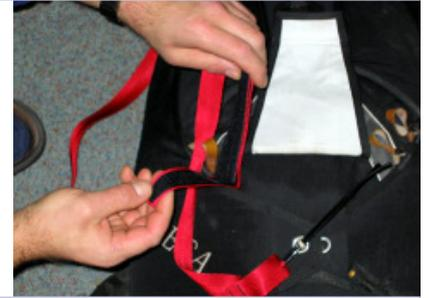
Velcroverbindung zum Federhilfsschirm anbringen
