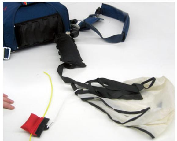
Ist der zusätzliche Hilfsschirm im Luftstrom, wird die HD Tasche angehoben und die Hilfsschirmverbindungsleine gestreckt.
