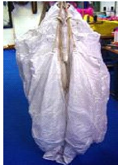
3. Die jeweils 4 äußeren Zellen werden zur Mittelzelle hin 3-4 mal eingedreht.
