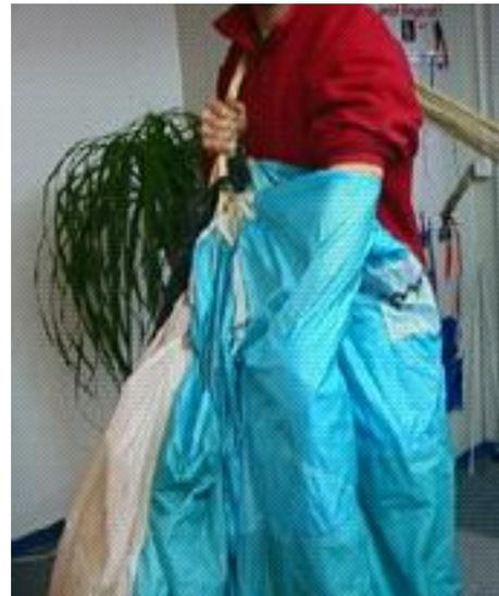
5. Verfolgen Sie die D-Leinen einer Seite mit der Hand, ziehen diese leicht heraus und legen Sie diese zur Kappenmitte so ab, daß sich zwischen den C und D-Leinen gleichfalls ein S-Schlag bildet.
