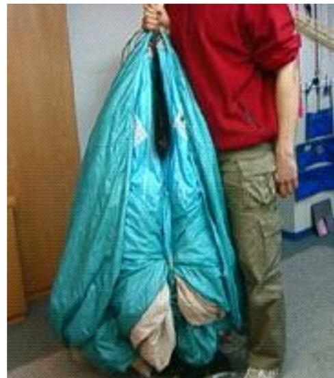
8. Sortieren Sie den Slider so, daß er sternförmig an der Basis der Kappe liegt. Ergreifen Sie die Steuerkante der Mittelzelle und ziehen diese über den gesamten Schirm.
