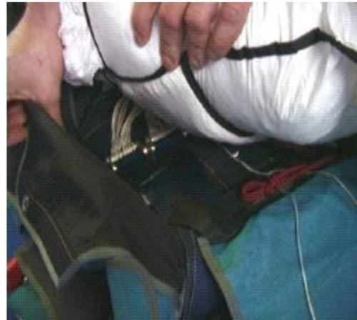
11. Das Freebag wird mit den Leinen nach unten in den Container gelegt, das Loop durchgeführt und die erste, untere Klappe geschlossen. Auf dieser Klappe befindet sich auch der Cypres-Cutter.
