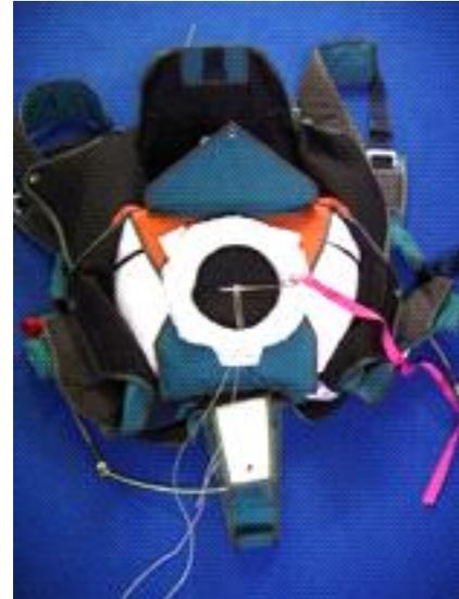
16. Schließen Sie die Spiegel-Klappe und danach die beiden seitlichen Klappen.....
