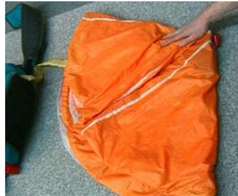
24. Verschließen Sie alle Klappen des Containers so, daß weder die Kill-Leine noch die Verbindungsleine des Drogue-Chutes sichtbar ist.
