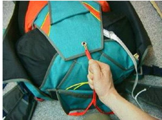
20. Befestigen Sie das Drogue-Release-Drei-Ring mit dem durchlaufenden Doppel-Loop. Danach wird der Drogue-Chute bis zum Anschlag der Kill-Leine dekolabiert .
