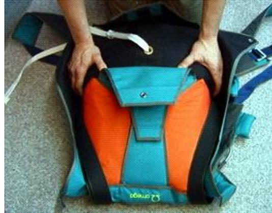
19. Der Container des Hauptschirmes wird in der Reihenfolge: Unten, oben, rechts, links verschloßen. Dabei wird die Kill-Leine des Drogue-Chute unten rechts herausgeführt. Verschließen Sie den Container mit dem Pin.
