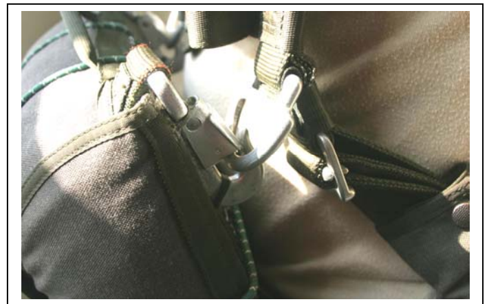
Abb. 27 tragende Verbindung zum Sprungfallschirm
