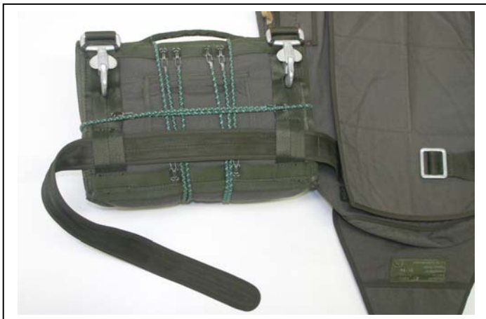
Abb. 26 nicht tragende Verbindung zum Sprungfallschirm
