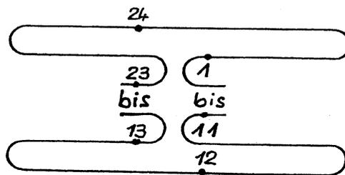
Dieses Schema stellt den Anblick auf die Basis der gelegten Fallschirmkappe, aus der Richtung des Verpackungssackes her, dar. Die mit Zahlen bezeichneten Punkte bedeuten die entsprechenden Fangleinen.
