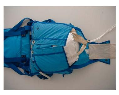
Abb. 14 Verschließen des Verpackungssackes
