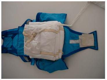
Abb. 13 Einlegen des Verzögerungssackes in den Verpackungssack
