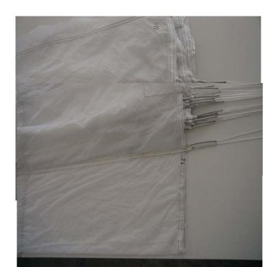
Abb. 7 Ablegen der Fallschirmkappe auf den Packtisch
