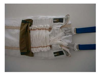
Abb. 12 Fangleinen eingeschlauft
