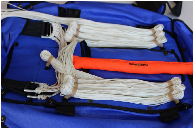
Abb. 18 Einschlaufen der Fangleinen
