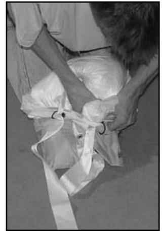
Enfilez les plis dans le sac de déploiement et verrouillez le.
