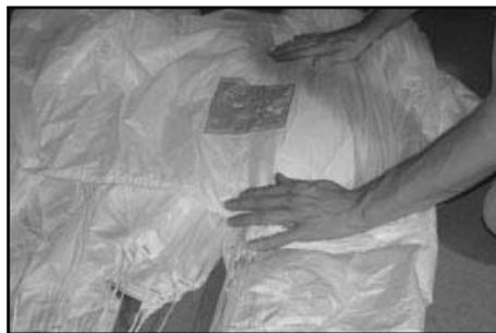
Ce panneau doit être placé au centre entre les deux groupes d'élévateurs.
